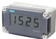
SITRANS RD100 представляет собой простой двухпроводной удаленный цифровой индикатор NEMA 4X в корпусном исполнении с питанием от контура 4..20мА, предназначенный для работы с контрольно-измерительной технологической аппаратурой. Простая калибровка, состоящая из двух операций. Два режима работы входа позволяют легко осуществлять обслуживание без необходимости отключения контура.
