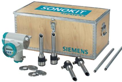
SONOKIT это комплект, состоящий из ультразвуковых сенсоров, которые монтируются на существующем трубопроводе, вторичного преобразователя, кабеля. Комплект предназначен для монтажа на пустые трубы или трубы под давлением без остановки трубопровода процесса (установка по методу Hot-Tap). В системе SONOKIT электроакустические преобразователи находятся в протоке (смачиваются жидкостью). Поэтому точность измерения и производительность значительно лучше, чем у доплеровских или накладных расходомеров.
