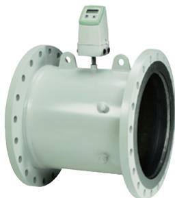
Расходомер SITRANS FUS380 (2-х трековый) поставляется с аккумуляторной батареей или питается от сети. Он предназначен для измерения расхода воды в районных отопительных котельных, местных сетях, котельных, подстанциях, охладительных установках, ирригационных установках и других сферах, использующих воду в общих целях.
