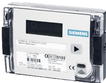
SITRANS FUE950 – универсальный теплосчетчик для учета тепловой энергии горячей воды. SITRANS FUE950 предназначен для применения с ультразвуковыми расходомерами SITRANS FUS380/FUE380, также возможно применение с расходомерами MAG 5000/6000 и FST020. SITRANS FUE950 имеет модульную конструкцию и может быть заказан в конфигурации, которая максимально соответствует конкретному применению.
