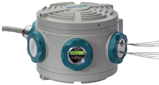
Полевой взрывозащищенный газовый хроматограф MicroSAM (Micro Single analyzer module) выполнен на базе кремниевой микромеханики. Это позволило сделать его миниатюрным при одновременном увеличении аналитических возможностей и расширении функциональности. В прочном, взрывозащищенном корпусе хроматографа MicroSAM располагаются модули электроники, пневматики и аналитический тракт с бесклапанным вводом пробы и переключением колонок.
