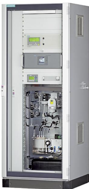
Комплекс для мониторинга промышленных выбросов разработан для непрерывного измерения CO, SO<sub>2</sub>, NO, O<sub>2</sub>, а также других компонентов (CO<sub>2</sub>, NO<sub>x</sub>, HCl, HF, NH<sub>3</sub>, H<sub>2</sub>O) в отходящих газах.
