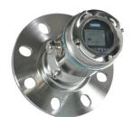
SITRANS LR560 — первый 2-х проводный радарный уровнемер, работающий на частоте 78 ГГц с технологией FMCW (частотная модуляция с Фурье анализом) для непрерывного измерения уровня сыпучих продуктов в силосах высотой до 100м. Он предлагается в двух модификациях: 40 м / 100°C и 100 м / 200°C. Этот уровнемер имеет очень узкий пучок  $4^{\circ}$ , короткую волну, линзовую антенну и работает в режиме «включай и работай». Технология развитой обработки отраженного сигнала Process
