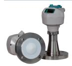
SITRANS LR250 с фланцевым соединением и антенной в корпусе является 2-х проводным, импульсным (25ГГц) радарным уровнемером для непрерывного мониторинга жидкостей и шламов в резервуарах и технологических емкостях, в том числе и для агрессивных веществ или материалов, в диапазоне от 0 до 20 м (в зависимости от антенны).
