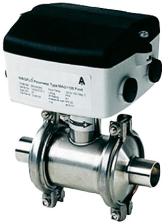
Электромагнитный расходомер Siemens SITRANS F M MAGFLO MAG 1100 Food специально разработан для использования в пищевой, пивобезалкогольной и фармацевтической промышленности. Монтаж в систему осуществляется с помощью различных гигиенических адаптеров. Расходомер MAGFLO состоит из датчика расхода MAG 1100 Food и электронного преобразователя сигналов MAG 5000 или MAG 6000.
