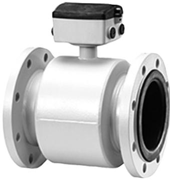
Электромагнитный расходомер Siemens SITRANS F M MAGFLO MAG 3100 подходит для измерения расхода практически в любых условиях. Монтаж в систему осуществляется с помощью фланцев. Широкий спектр материалов футеровки и электродов, стойких к самым агрессивным веществам. Расходомер MAG 3100P состоит из датчика расхода MAG 3100 и электронного преобразователя сигналов MAG 5000 или MAG 6000.
