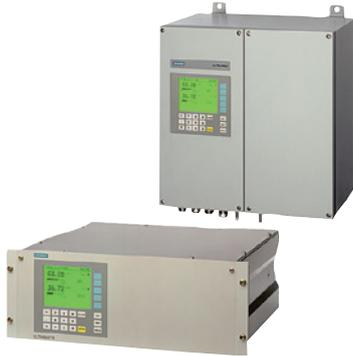
Газоанализатор Ultramat 6 представляет собой высокоточный микропроцессорный прибор с инфракрасным фотометром в качестве детектора и предназначен для определения содержания газов, поглощающих электромагнитное излучение в инфракрасном диапазоне спектра (CO, CO<sub>2</sub>, SO<sub>2</sub>, CH<sub>4</sub>, NO<sub>x</sub>, NH<sub>3</sub>, CH<sub>n</sub> и др.) в воздухе, технологических газовых потоках и дымовых газах.
