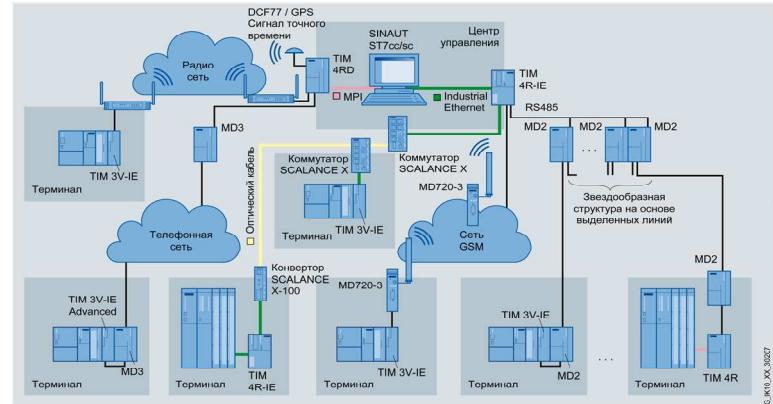
защищенных VPN-соединений. В качестве связи с приложениями центральной станции сбора данных используется OPC-интерфейс.
