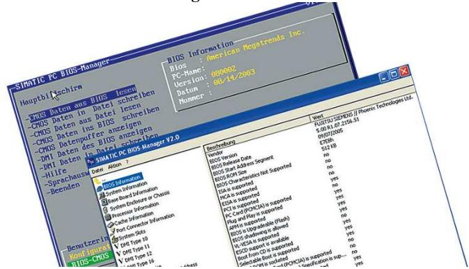
Пакет SIMATIC PC BIOS Manager содержит набор инструментальных средств для работы с CMOS и DMI данными BIOS компьютера, описывающими параметры его конфигурации. Он позволяет:
