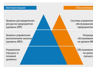
PCS7 Asset Management оснащает SIMATIC PCS7 инструментальными средствами, позволяющими снизить общую стоимость затрат на обслуживание предприятия. В системе управления Asset Management выполняет функции управления оборудованием предприятия, а также все действия, направленные на диагностику, поддержание и обслуживание средств автоматизации.
