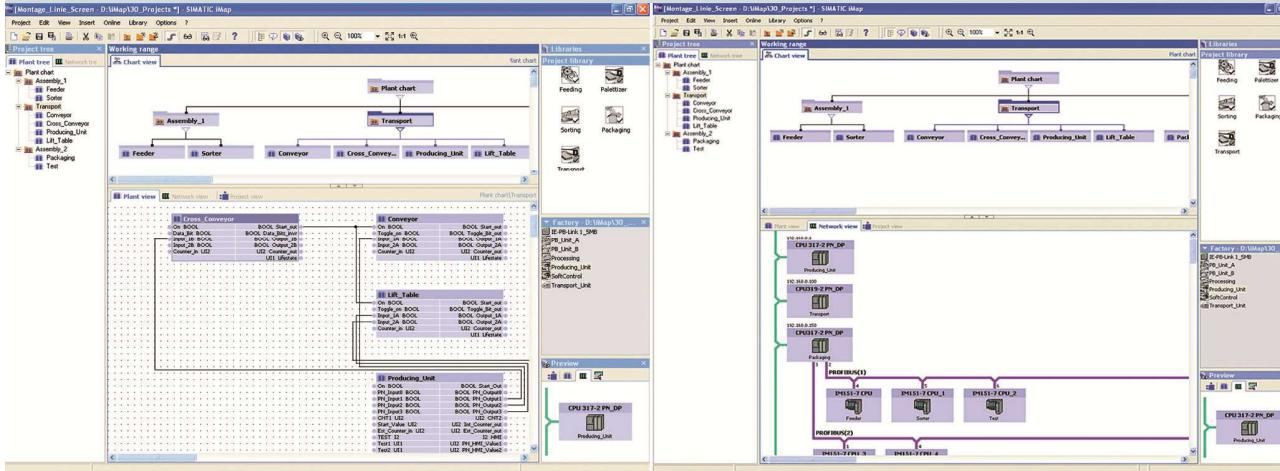
Технология СВА призвана упростить вопросы организации промышленной связи через PROFINET между оборудованием различных производителей. При этом операции трудоемкого программирования систем связи заменяются операциями графического проектирования таких систем.
