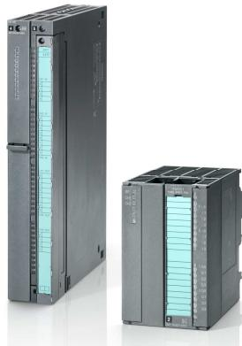
FM 351 позволяет выполнять позиционирование по двум, FM 451 – по трем осям. Каждый канал позиционирования оснащен 4 дискретными входами, 4 дискретными выходами, а также интерфейсом для подключения датчика положения.
