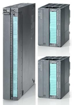
FM 453 сочетает в себе функциональные возможности модулей FM 353 и FM 354. Он способен управлять работой до трех приводов с шаговыми или серводвигателями. Каждый канал позиционирования оснащен импульсным и аналоговым выходом. В зависимости от типа подключаемого привода в работу включается только один из этих выходов.
