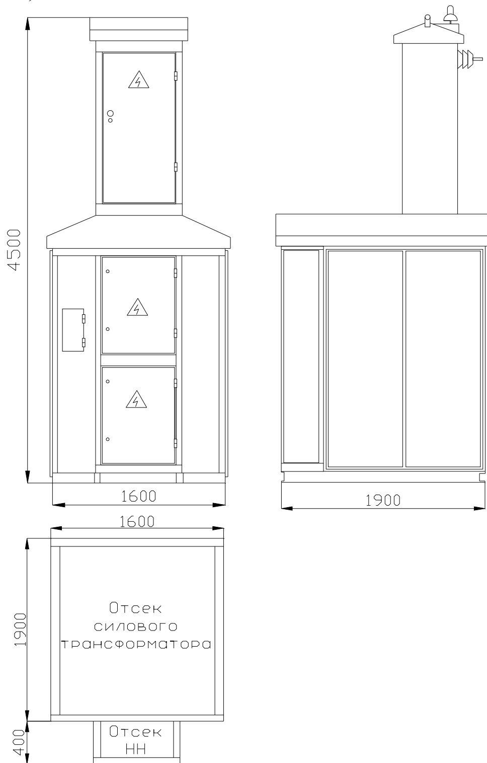
Рис. 1.10 Габаритные размеры и опорный пояс КТПН 63-160кВА
