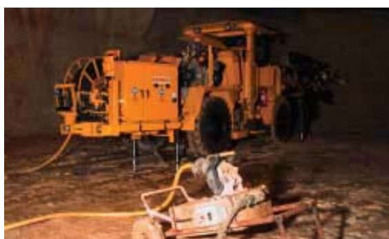
Барaban и разъёмы Savotec в шведской шахте
