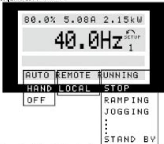
В левой части строки состояния указывается элемент управления преобразователя частоты VLT, который активен. AUTO (АВТОМАТИЧЕСКИЙ) означает, что управление происходит через клеммы управления, в то время как HAND (РУЧНОЙ) указывает на то, что управление происходит через кнопки на панели управления.
