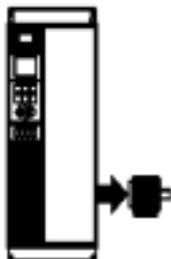
1. Если должны быть выполнены требования типа UL/cUL, то следует использовать предохранителя типа Bussmann KTN-R, KTS-R. Предохранители должны устанавливаться для защиты схемы, которая может быть запитана максимальным эффективным током в 100,000 А (симметрично), с максимальным напряжением 500 В.
