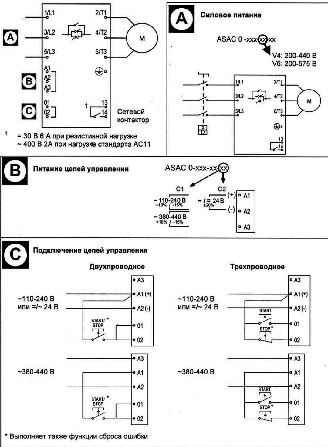
Серия устройств плавного пуска ASAC состоит из двух различных групп – ASAC-0 и ASAC-1. Эти группы имеют одинаковую силовую часть, но отличаются набором функций. Приборы обеих групп имеют встроенный шунтирующий контактор, отключающий тиристоры по окончании пуска. Это обеспечивает возможность установки ASAC в вентилируемых электрошкафах без необходимости установки внешнего шунтирующего контактора.
