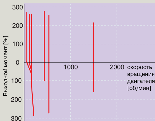
Характеристики момента при использовании векторного контроля динамического момента ( пример: G11S 4,0 кВт)
