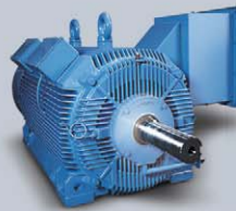
Двигатель серии H AC • 150 – 1,000лс • 2,000 – 7,200В, 50/60 Гц • 2 – 8-х полюсный
