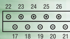
Рисунок Г. 1. Расположение контактов колодки трехфазных счетчиков «Меркурий 230» для подключения интерфейсов CAN, RS-485, импульсных выходов
