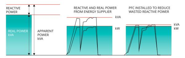
SMALLER GAP EQUATES TO LOWER FACTOR AND REDUCED ELECTRICITY BILL SUPPLIERS CHARGE FOR TOTAL kVA
