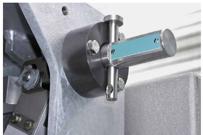
Fig. 4.1-22: 3AP2 DCB interlock indicator
