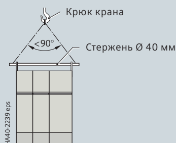
Транспортировка краном с помощью стержня
