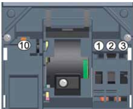
Расположение отсеков дополнительных устройств в 3VT2
