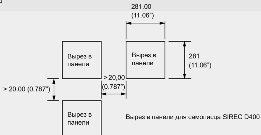
SIREC D400, размеры в мм (дюймах) и вырез в панели
