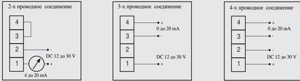
Рис 3/89 Сельсин-измерительный преобразователь SITRANS FVA 252, схемы соединения
