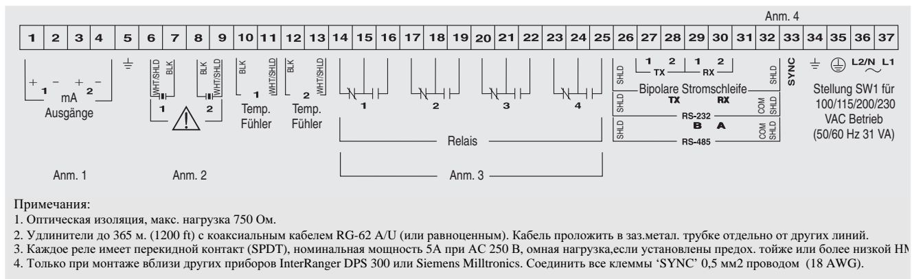
Рис 4/54 Схема соединения InterRanger DPS 300
