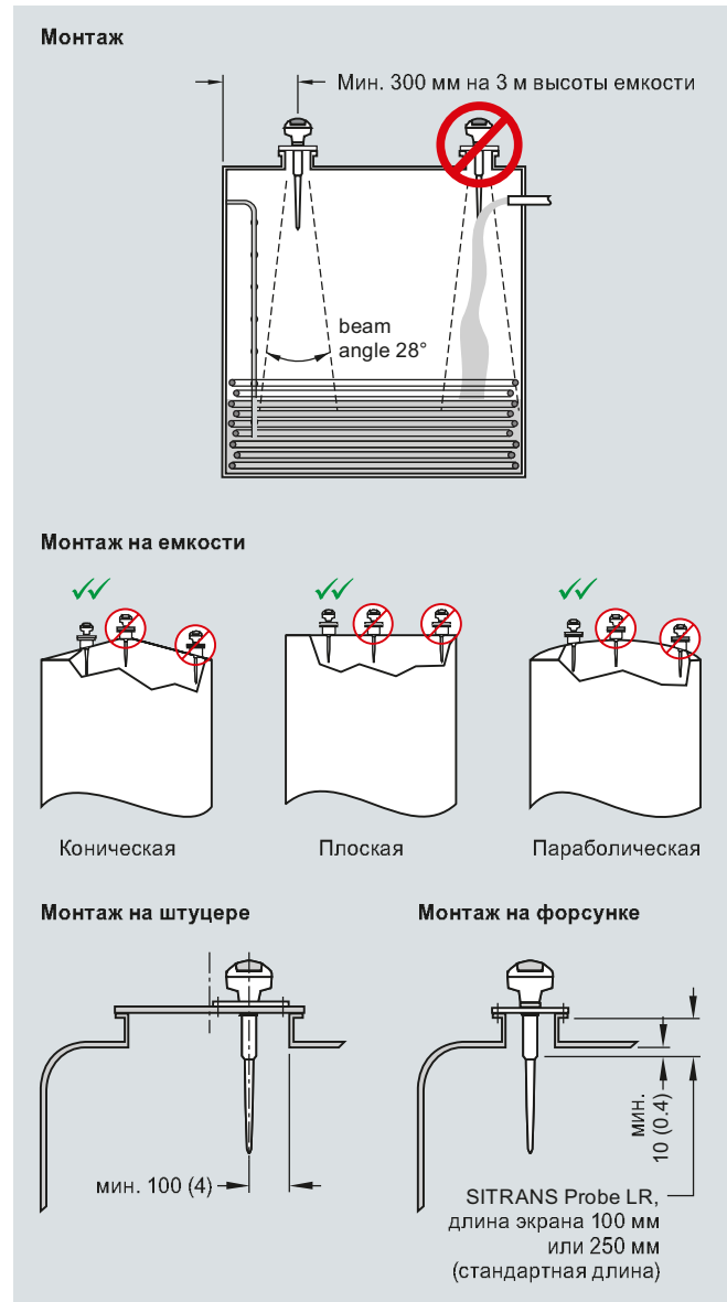
Монтаж SITRANS Probe LR, габариты в мм
