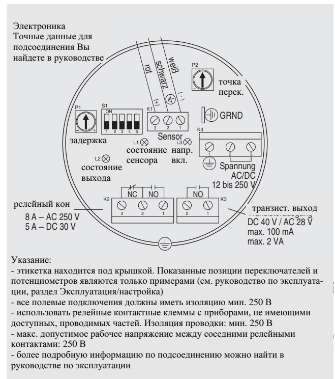
Рис 4/9 Соединения Pointek CLS 200
