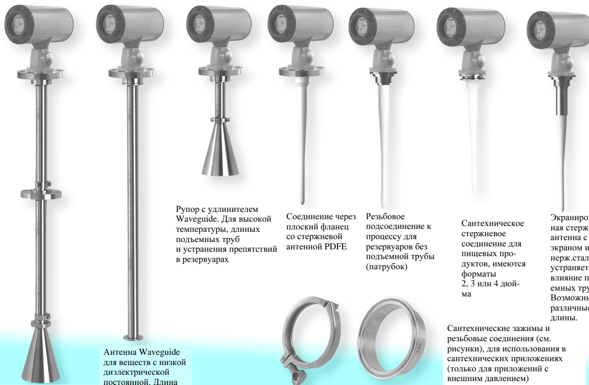
Рис 4/79 Конфигурации антенн для SITRANS LR 300 и LR 400
