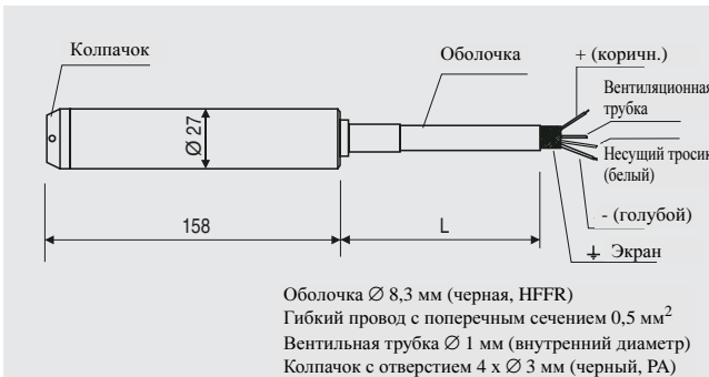
Рис 1/9 Измерительный преобразователь избыточного давления 7MF1570, размеры
