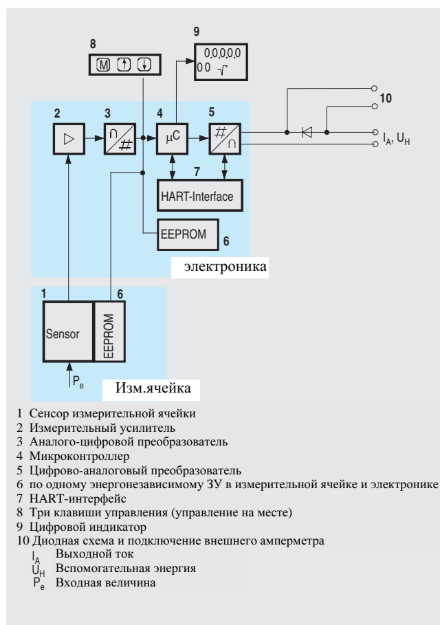
Рис 1/22 Измерительный преобразователь SITRANS P, серия DS III, электроника
