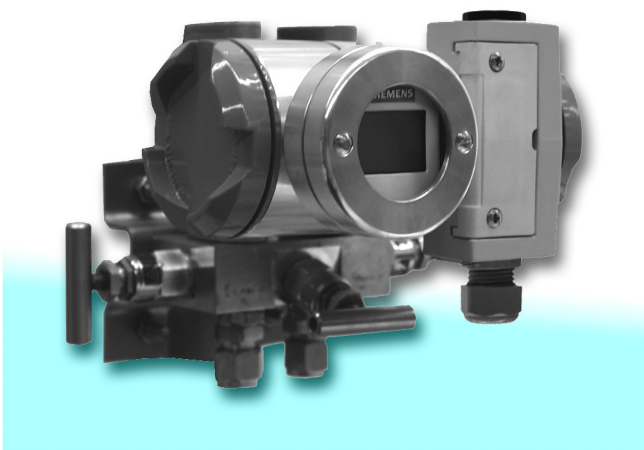
Рис 1/43 Измерительный преобразователь SITRANS P серии DS III и DS III PA для дифференциального давления и расхода с цифровым индикатором рядом с клавишами управления
