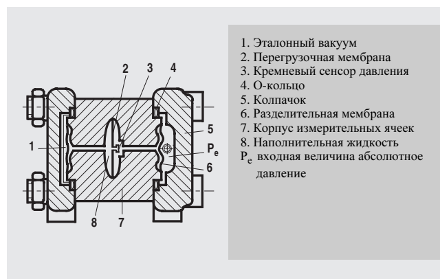
Рис 1/35 Измерительная ячейка для абсолютного давления из серии "Дифференциальное давление", функциональная схема
