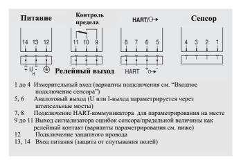
Схема соединения для питания, входа и выходов
