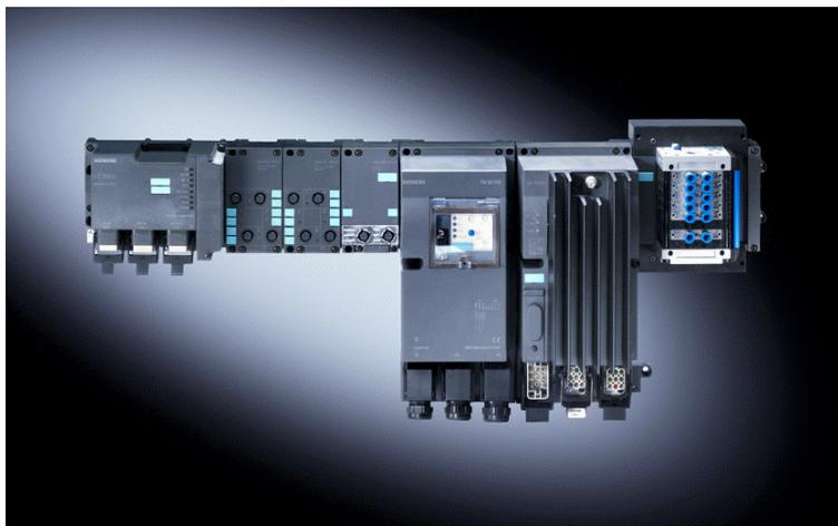
Модульная станция SIMATIC ET 200X имеет степень защиты IP 65/IP 67 и может монтироваться непосредственно на управляемом оборудовании вне шкафов управления. Подключение к сети PROFIBUS-DP производится через базовый модуль. К одному базовому модулю может подключаться до 7 модулей расширения.
