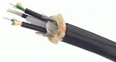
Волоконно-оптический кабель для подключения аппаратуры, установленной на подвижных частях технологического оборудования. Может поставляться отрезками фиксированной длины с 4 установленными BFOC соединителями.
