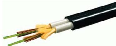
Кабель без содержания галогена, не выделяющий вредных газов при горении, предназначенный для прокладки в помещениях. Может поставляться отрезками фиксированной длины с 4 установленными BFOC соединителями.
