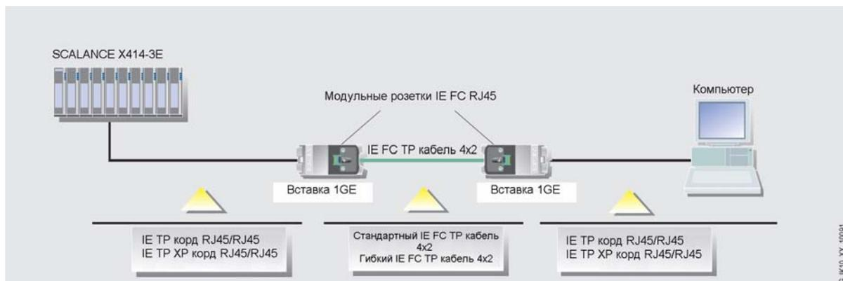
Использование IE TP кордов RJ45/RJ45 для подключения сетевых компонентов к линиям связи на основе IE FC TP кабелей 4x2 через модульные розетки IE FC RJ45 (10/100/1000 Мбит/с)
