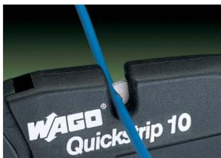
Quickstrip 10. Отрезание провода.
