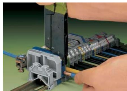
Плунжер устанавливается в верхнее рабочее отверстие клеммы с боковым подключением, при этом скоба фиксируется в боковом рабочем отверстии. Контакт полностью открывается при сжатии ручек инструмента, и удерживается в открытом состоянии храповым механизмом, освобождая обе руки монтажника для установки проводника. При последующем повторном сжатии ручек храповой механизм освобождается, провод зажимается в клемме и инструмент снимается с клеммы.
