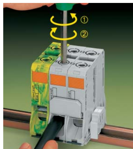
. . . коротким поворотом ключа влево расфиксировать стопор ①. Повернуть ключ вправо и вынуть его из клеммы ② Проводник надежно зажат в клемме.
