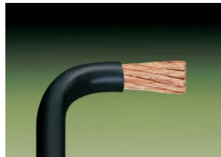
Изоляцию снимать только после изгиба проводника! Срез проводника должен быть прямым!
