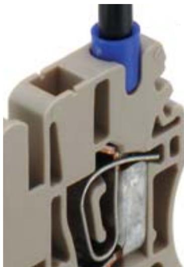
Клетка пружинной клеммы выполнена с запасом по максимальному сечению провода и габаритам изолированного кабельного наконечника, что снижает стоимость и повышает компактность монтажа. Запас по сечению позволяет зажимать в клемму провод с обжатым изолированным кабельным наконечником без снижения максимального значения сечения подключаемого провода.
