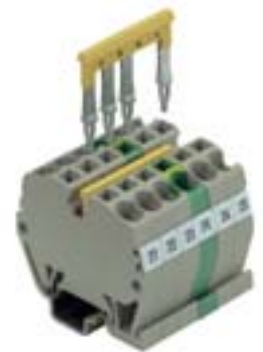
удалив один из элементов мостика, можно “обойти” одну или несколько клемм
